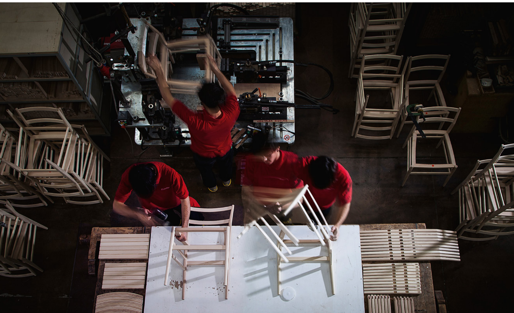
Falegnameria Cassina, assemblaggio della sedia Leggera di Gio Ponti - Collezione Cassina iMaestri, ph. © Stefano De Monte
